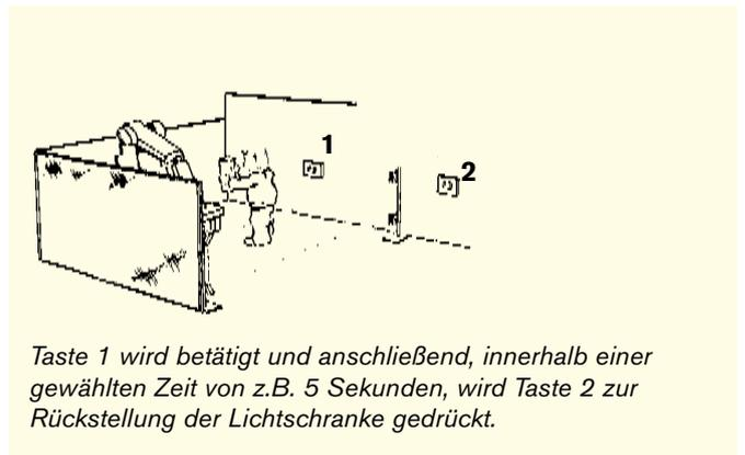
Taste 1 wird betätigt und anschließend, innerhalb einer gewählten Zeit von z.B. 5 Sekunden, wird Taste 2 zur Rückstellung der Lichtschranke gedrückt.
