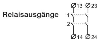
Das RT9 verfügt über zwei Schließer Sicherheitsausgänge.
