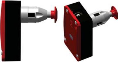
Die elektromagnetische **proLokIR** Einheit steuert Abläufe mithilfe eines elektromagnetischen Elements. Drei Basistypen sind verfügbar: Standard, AS-i und mit individuellen Sicherheitskontakten. Alle Varianten besitzen einen Mechanismus zur Überwindung der elektromagnetischen Zuhaltung. Der Drucktaster ist für Wandstärken bis 55 mm ausgelegt. Eine Verlängerung für größere Abstände ist möglich.
